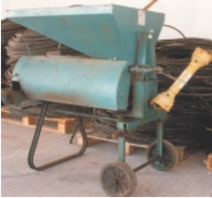
11.- Peladora de almendras utilizada, después de ligeros cambios, para el pelado de los frutos de pistacho.
